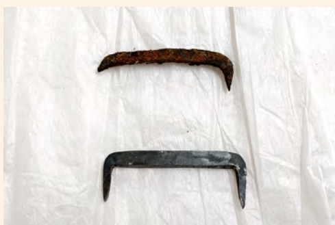
図 58：撤去した鋸(上)と新調した鋸(下)
